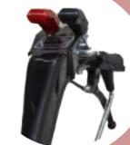
Tracción con **bloqueo y desbloqueo del diferencial.**
