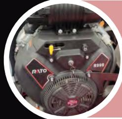
Motor **RATO V-TWIN** de 999 cc bicilíndrico con arranque eléctrico.
