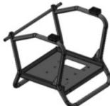
Inserte las ruedas en los ejes del bastidor y después coloque las arandelas Ø8\*28\*3, las arandelas grower M8 y por último inserte los tornillos M8x20, apriételos hasta que las ruedas queden bien sujetas.
