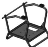
Insérez les roues dans les axes du cadre puis placez les rondelles Ø8\*28\*3, les rondelles grower M8 et enfin insérez les vis M8x20, serrez-les jusqu'à ce que les roues soient bien fixées.
