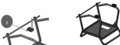
Inserire le ruote negli assi del telaio e poi posizionare le rondelle Ø8\*28\*3, le rondelle grower M8 e infine inserire le viti M8x20, serrarle fino a fissare saldamente le ruote.
