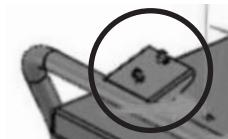
Abbinarli alla base di fissaggio del pulsante di sicurezza e fissarlo utilizzando le 2 viti M6x16, le due rondelle grower M6 ed i controdadi M6.
