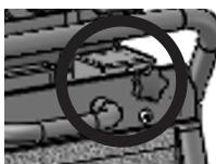
Empuje la bolsa recolectora por su riel. Atornille la perilla sobre el interruptor de bloqueo.
