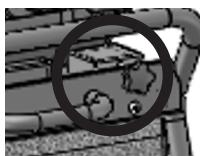
Spingere il sacco di raccolta lungo la sua guida. Avvitare la manopola sull'interruttore di blocco.
