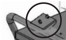
Associez-les à l'embase de fixation du bouton de sécurité et fixez-le à l'aide des 2 vis M6x16, des deux rondelles grower M6 et des contre-écrous M6.
